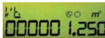
Esempio per visualizzazione a display della data dell'ultimo consumo su registro interno del contatore – icona principale D, icona secondaria F
